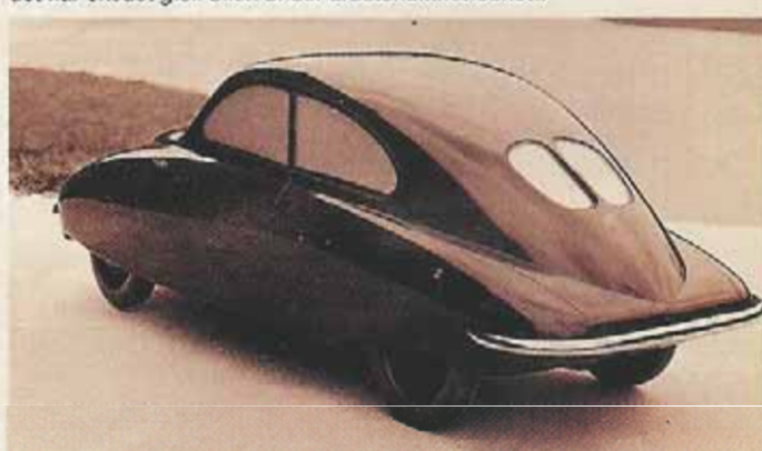
En tidig trämodell i liondels skala, som sedan ledde till den första prototypen. Denna modell användes såväl för visningsändamål som vid vindtunnelprov. Saaben hade mycket lågt luftmotstånd.
